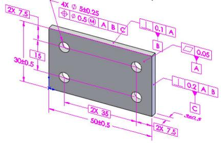
2Определение по обозначению на чертеже вида допускаемых отклонений расположения поверхности, допуски расположения поверхности, базы изготовления и контроля
