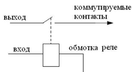
Гальваническая развязка на основе реле
