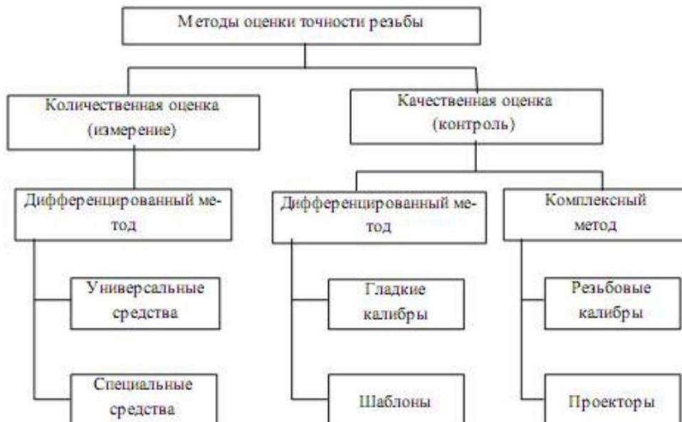
Рис. 2. Классификация методов оценки точности резьбы.
