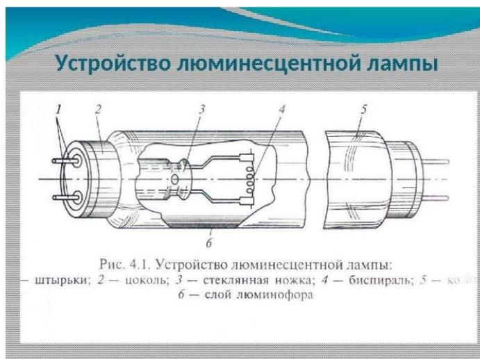
Рис. 4.1. Устройство люминесцентной лампы: 1 — штырьки; 2 — цоколь; 3 — стеклянная ножка; 4 — биспираль; 5 — цоколь; 6 — слой люминофора
