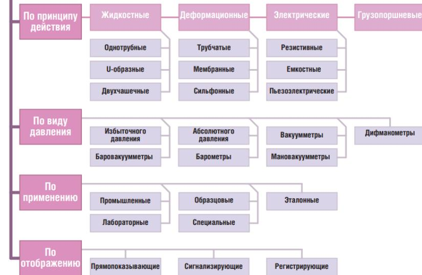
Рис. 3. Классификация манометров
