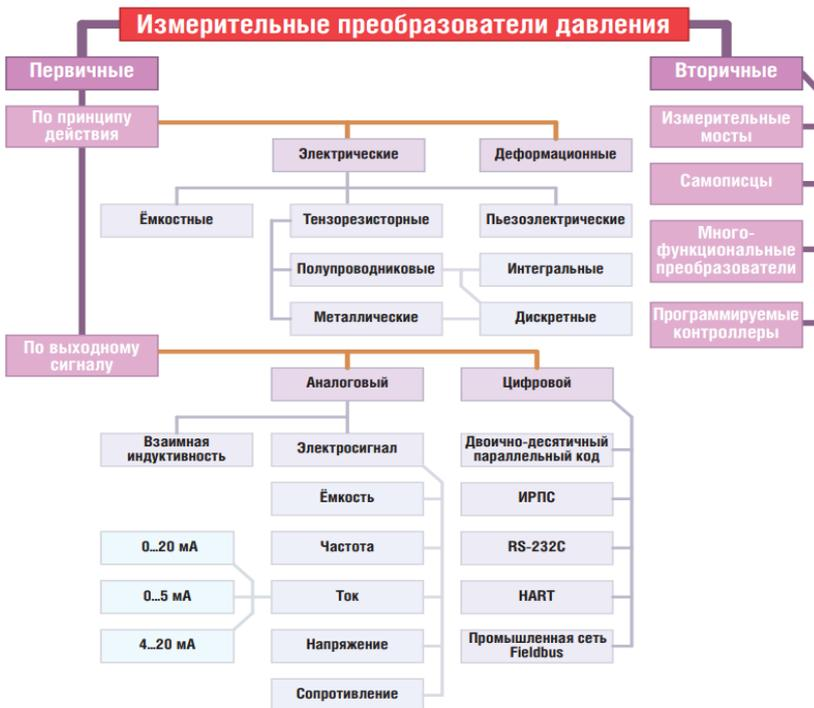
Рис. 4. Классификация измерительных преобразователей давления
